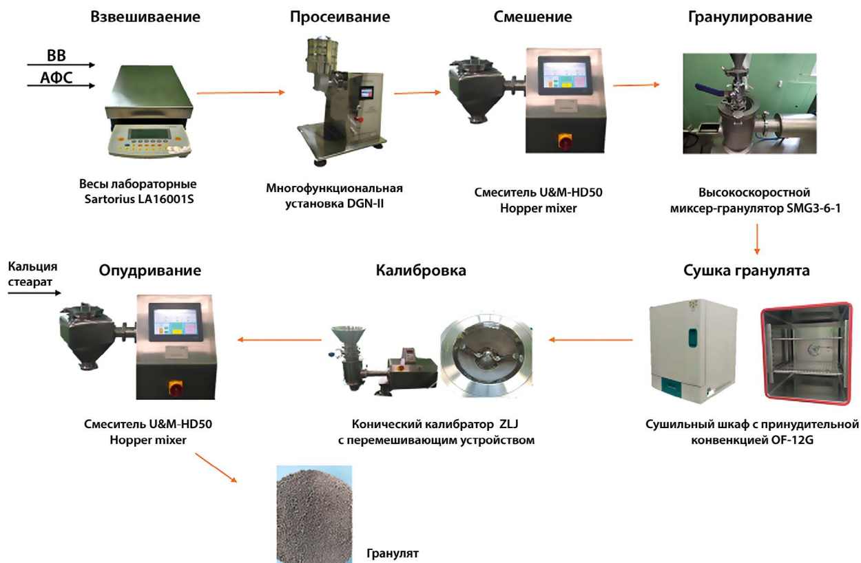
Рисунок 1. Маппинг процесса гранулирования
