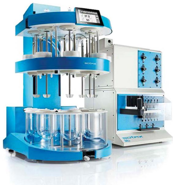
Полностью автоматизированная настольная система растворения AT MD поддерживает проведение теста «Растворение» по методам USP 1 (вращающаяся корзинка), USP 2 (лопастная мешалка) с возможностью задействовать в этом процессе грузила (в т. ч. грузила японского типа) для предотвращения всплывания капсул на поверхность среды растворения. Программное обеспечение SOTAX AT MD полностью соответствует 21 CFR, часть 11.
