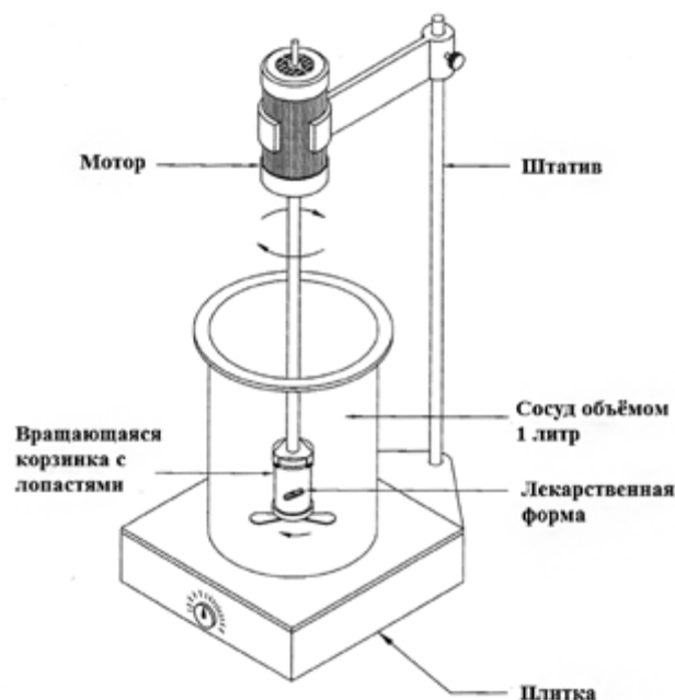
Рисунок 3. Один из ранних экспериментальных вариантов аппарата растворения
