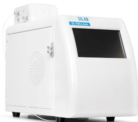
органических соединений, содержащихся в исследуемых пробах воды, применяется двухволновая (185/254 нм) лампа, что обеспечивает низкие пределы обнаружения в 1 мкг/л (ppb).
