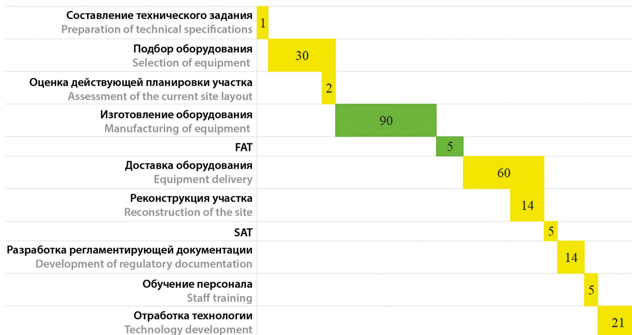
Рисунок 4. Временная диаграмма Ганта масштабирования процесса нанесения пленочного покрытия
