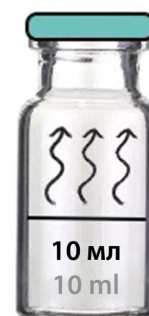
Рисунок 2. Флакон, используемый для анализа герметизирующих материалов
