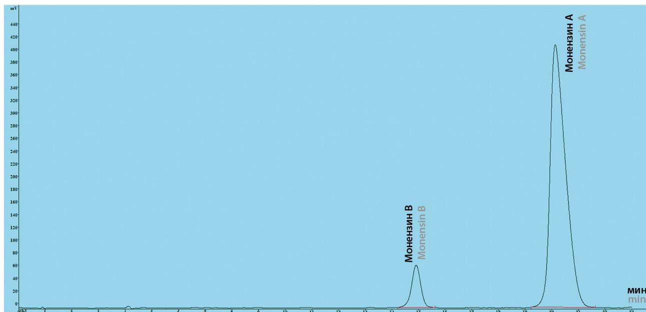
**Рисунок 10.** Хроматограмма монензина, полученная на модификации аминокислотного анализатора АКА-1000: скорость потока подвижной фазы – 0,85 мл/мин; скорость потока дериватизирующего реагента – 0,9 мл/мин;  $\lambda = 520$  нм;  $V = 5$  мкл;  $T_{\text{колонок}} = 25$  °С;  $T_{\text{реактора}} = 98$  °С
