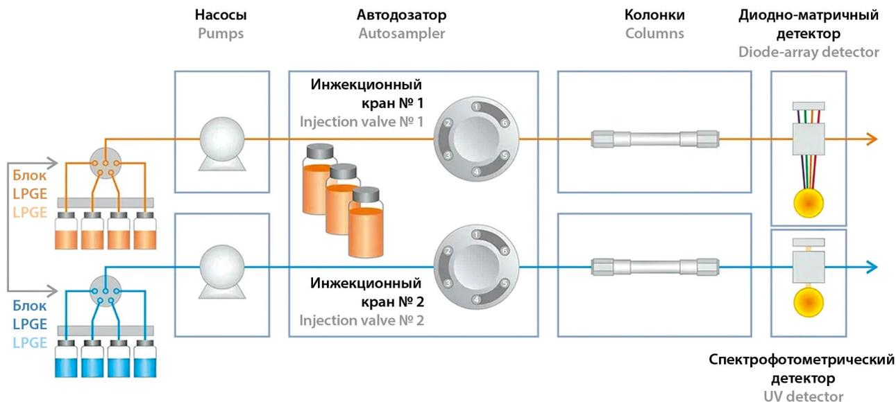
Рисунок 4. Двухканальная ВЭЖХ-система «Скореход» с единым автодозатором
