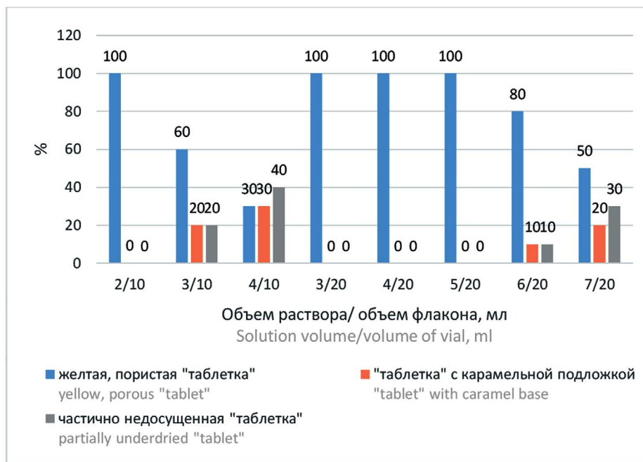
Рисунок 4. Влияние объема флакона и объема заполнения флакона на качество лиофилизата
