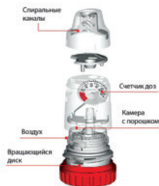
Рисунок 11. Строение девайса типа «турбухалер»
