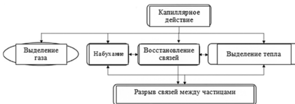
Рисунок 4. Схема механизмов дезинтегрирующего действия [13, с. 2553]
