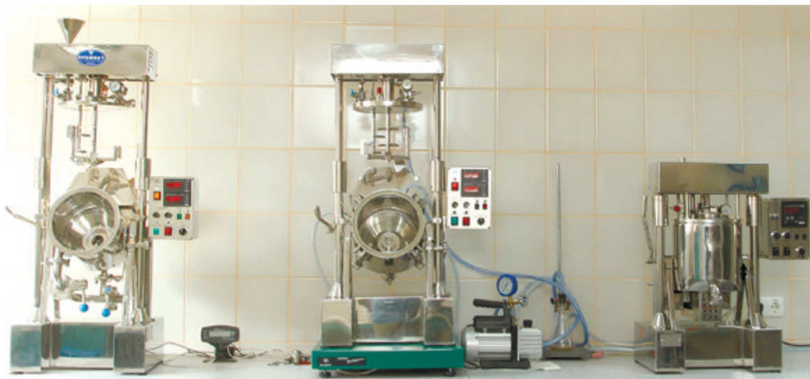
Рисунок 2. Вакуумные реакторы-гомогенизаторы (слева направо): РП-5-ВК, РП-5Д и РП-5 Примечание. Реактор РП-5Д может работать под давлением до 10 МПа
