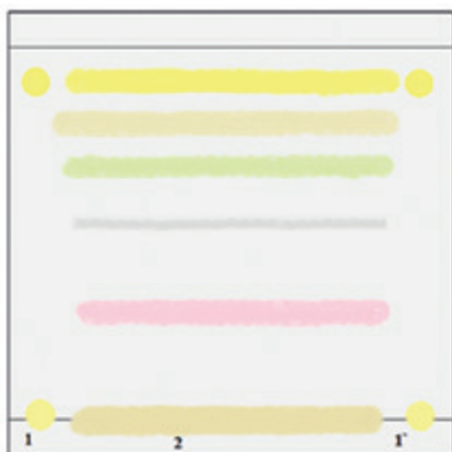
Рисунок 1. Хроматограмма экстракта, полученного из околоплодника ореха черного ( Juglans nigra L.): 1, 1' – пятно стандартного образца юглона, 2 – полоса нанесенного экстракта
