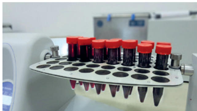
Рисунок 1. Моделирование взаимодействия с кровью в пробирке – программируемый ротатор с установленными в него пробирками с кровью
