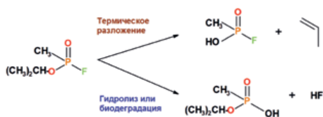
Рисунок 2. Образование двух типов продуктов деструкции зарина
