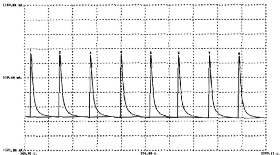
Рисунок 1. Выходной сигнал, получаемый от раствора рутина с концентрацией 5 мг/дм<sup>3</sup>
