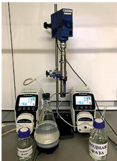
**Рисунок 2.** Установка для получения полимерных микро-частиц в проточном режиме
