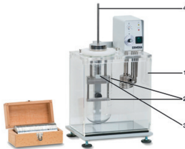
Рисунок 7. Прибор для определения устойчивости к разрушению суппозитория на липофильной основе ERWEKA SBT 2 (справа) и набор дисков (грузов) массой 200,0 г (слева)
