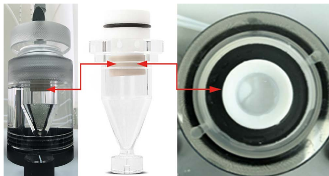
Рисунок 5. Проточная ячейка производства ERWEKA (Германия) для исследования высвобождения из пероральных ЛФ (диаметр 22,6 мм) с помещенным в нее адаптером для исследования мягких ЛФ (мази, кремы, гели)
