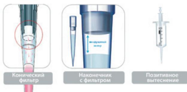
Рисунок 9. Дозаторы. Контаминация
