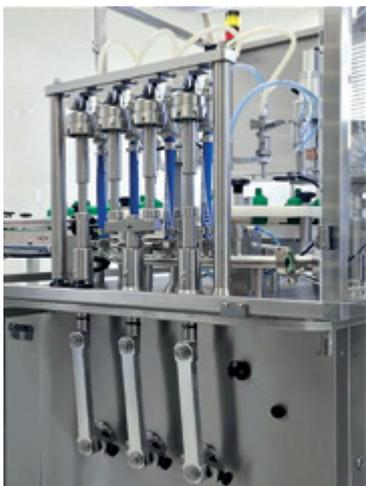
Рисунок 1. Модуль розлива машины Spectrum
