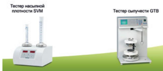
Рисунок 3. Тестеры контроля порошков и гранулятов
