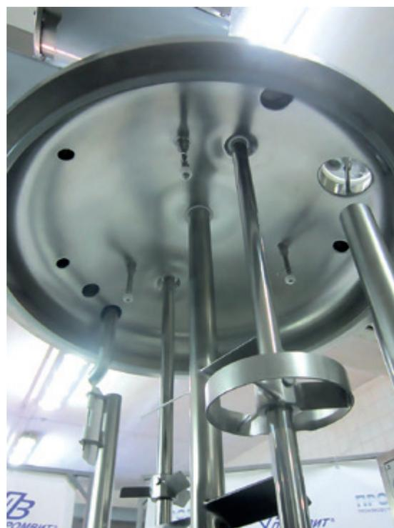
Три мешалки с приводами на крышке реактора
