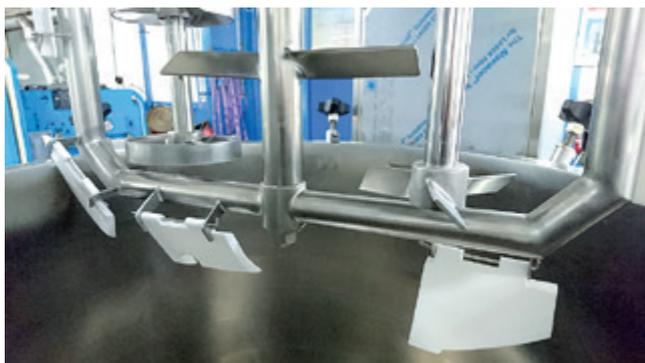
**Тихоходная якорная мешалка с плавающими скребками из тефлона; две быстроходные турбинные мешалки; якорь тихоходной мешалки с тефлоновыми скребками**
