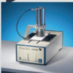
*miniGITA Star - сканирующее устройство, в котором столлик для образцов перемещается относительно детектора радиоактивности:*
