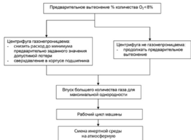
Рисунок 2. Измерение и контроль газовой среды путем измерения %  $O_2$
