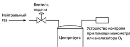
Рисунок 1. Ручной режим азотного инертирования
