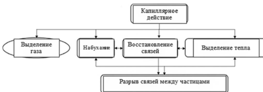
Рисунок 4. Схема механизмов дезинтегрирующего действия [13, с. 2553]
