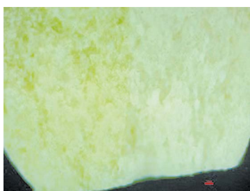
Рисунок 2. Двухслойная таблетка в разрезе (4-х кратное увеличение)
