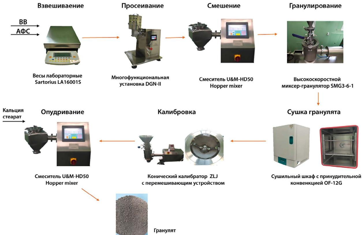
Рисунок 1. Маппинг процесса гранулирования
