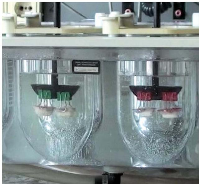
Рисунок 2. Контроль набухания и степени мукоадгезии таблеток методом гидродинамического смыва (wash-off)
