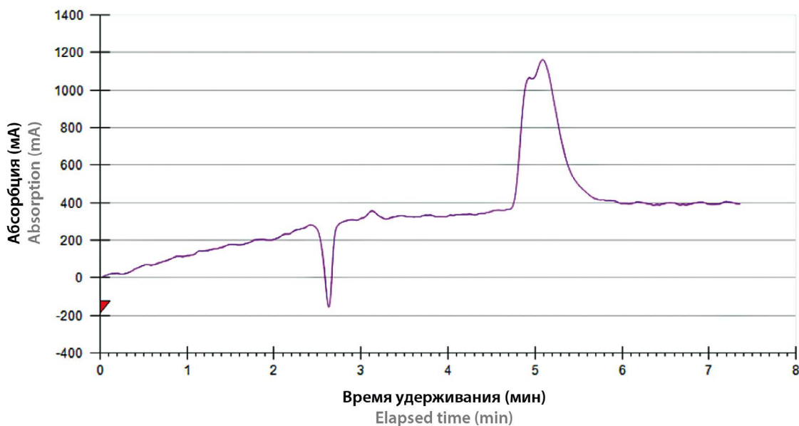
Рисунок 2. Хроматограмма энантиомеров салбутамола сульфата, полученная при апробации аналитической методики с параметрами: ПФ-сверхкритический \text{CO}_2 :метанол (80:20), динамический модификатор-изопропиламин (ИПА) 1 об. %, давление 120 бар, скорость потока 200 г/мин, объем вкола 2 мл, концентрация аналита 3 г/л на препаративном хроматографическом комплексе Prep 200 qSFC
