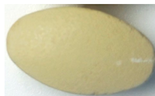
Рисунок 2. Белые полосы на таблетках, покрытых пленочной оболочкой
