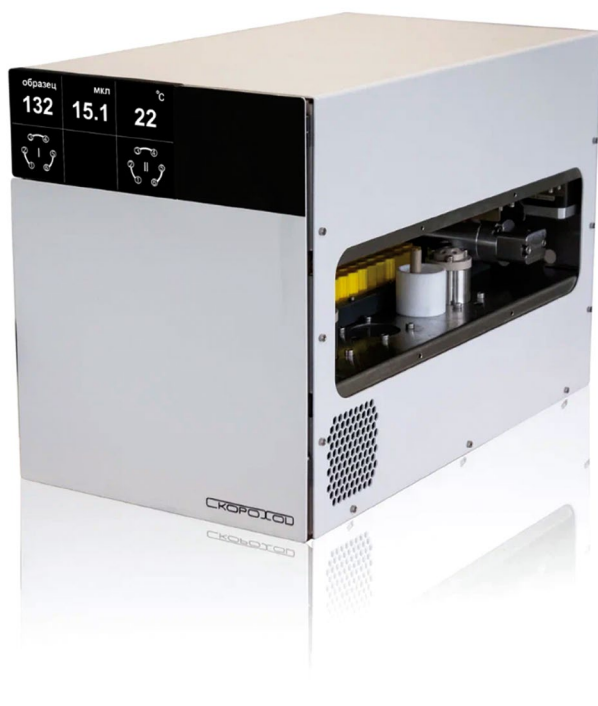
Рисунок 4. Боковая и передняя панели автодозатора «Скороход» с доступом к обслуживаемым узлам
