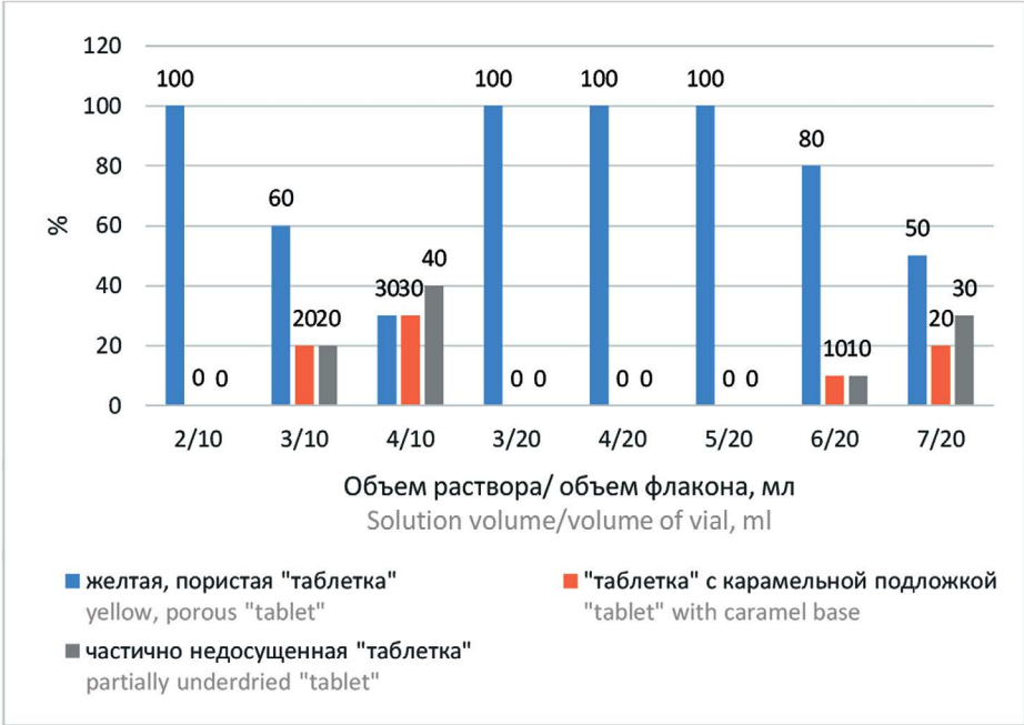
Рисунок 4. Влияние объема флакона и объема заполнения флакона на качество лиофилизата Figure 4. The influence of vial volume and vial filling volume on the quality of the lyophilisate
